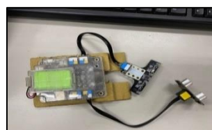
圖 14、安裝超音波感測器
